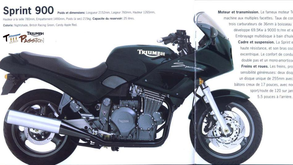
Moteur et transmission. Le fameux moteur Triumph trois cylindres de 885cc refroidi par eau anime cette machine aux multiples facettes. Taux de compression de 10.6 pour 1 - 76 x 65mm d'alésage/ course - trois carburateurs de 36mm à boisseau plat - allumage électronique digital à induction. Ce moteur développe 69.5Kw à 9000 tr/mn et envoie à la roue arrière un couple de 76.5Nm à 6500 tr/mn. Embrayage multidisque à bain d'huile - boîte 6. Régime maxi 9700 tr/mn.
