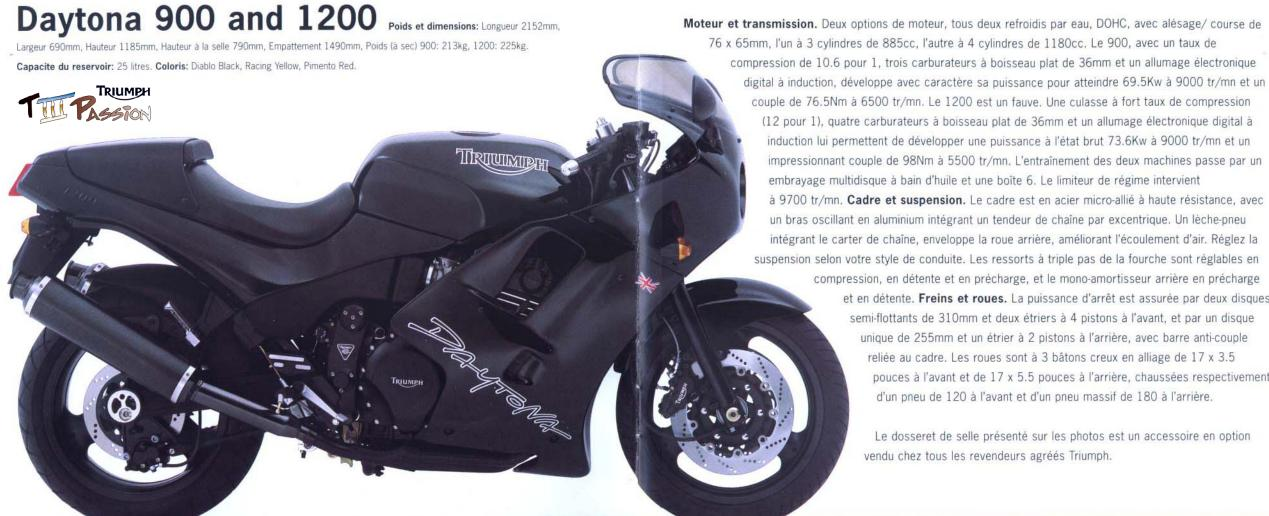
Moteur et transmission. Deux options de moteur, tous deux refroidis par eau, DOHC, avec alésage/ course de 76 x 65mm, l'un à 3 cylindres de 885cc, l'autre à 4 cylindres de 1180cc. Le 900, avec un taux de compression de 10.6 pour 1, trois carburateurs à boisseau plat de 36mm et un allumage électronique
