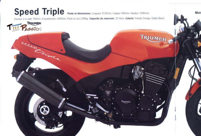
**Moteur et transmission.** Le fameux moteur Triumph trois cylindres DOHC refroidi par eau, dans sa version café racer. Alésage/course de 76 x 65mm - taux de compression de 10.6 pour 1 - trois
