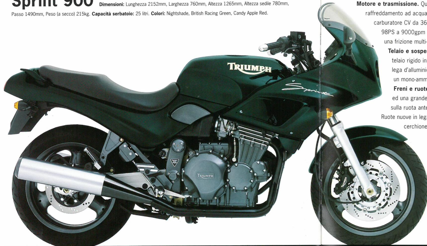
**Motore e trasmissione.** Questa moto versatile è dotata del motore Triumph da 885cc con tre cilindri e raffreddamento ad acqua. Rapporto di compressione 10.6:1, alesaggio e corsa 76 x 65mm, triplo carburatore CV da 36mm con valvola piatta, accensione elettronica ad induzione digitale, potenza di 98PS a 9000gpm e coppia motrice di 83Nm trasmesse sulla ruota posteriore a 6500gpm tramite una frizione multi-dischi in bagno d'olio e un cambio a 6 rapporti. Massimo di giri: 9700rpm.
