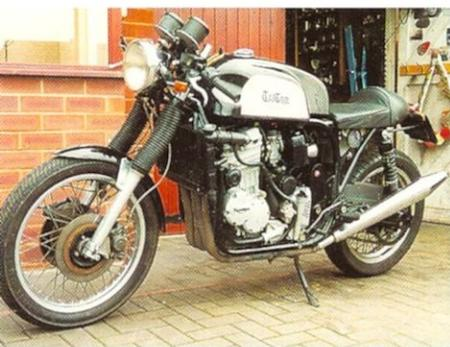
Con un telaio Wideline del '59 ed un motore 3 cilindri della Tiger, ecco fatto: questa special Café Racer.
