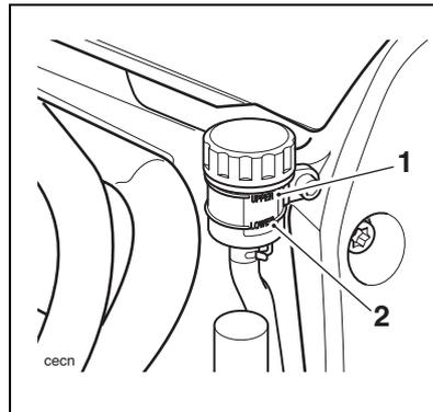
1. Serbatoio liquido freno posteriore, indice livello superiore
