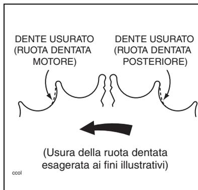
Se si riscontrano delle irregolarità, fare sostituire la catena di trasmissione e/o le ruote dentate presso un Concessionario Triumph autorizzato.
