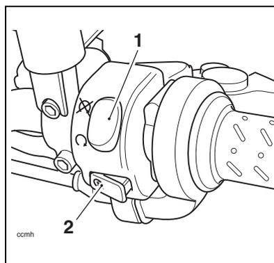
1. **Commutatore arresto motore**
