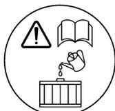
Allo scopo di garantire l'efficiente raffreddamento del motore, verificare ogni giorno il livello del liquido refrigerante prima di usare la motocicletta, e rabboccarlo se il livello è troppo basso.
