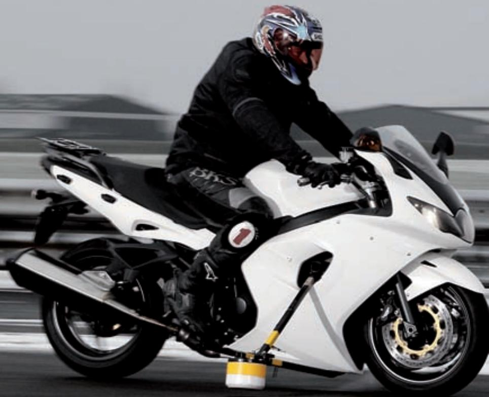
**SOPRA** I test di frenata di Triumph spingono le moto al limite, e la Sprint GT monta delle sporgenze di sostegno. La carena si può anche cambiare, ma è difficile trovare collaudatori esperti e preparati...
