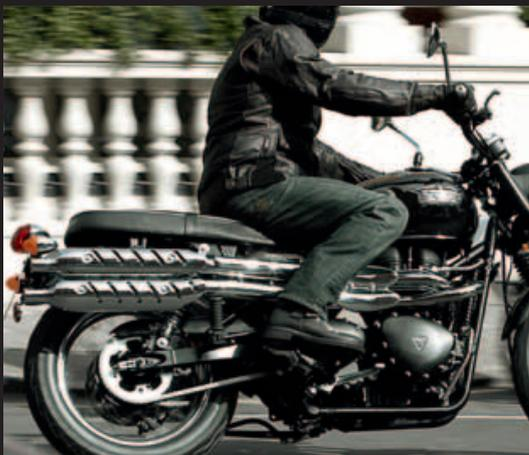
SCRAMBLER. Essenziale, decisa, da far girare la testa. Una moto, un mito hollywoodiano, con un tocco innovativo. Il nostro motore bicilindrico parallelo da 865cc a iniezione elettronica raffreddato ad aria, unitamente agli scarichi cromati alti posti lateralmente, dona un tocco distintivo. Soffiotti sulla forcella. Guida facile e rilassata. Ma eccitante al tempo stesso, sicura fin dal primo chilometro. Stile off-road retrò in chiave moderna.
