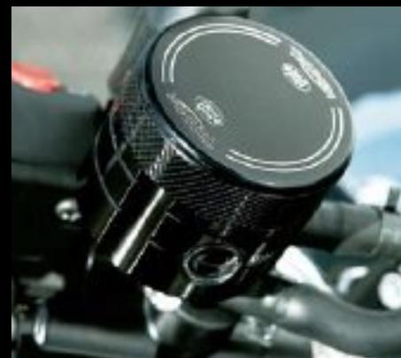
Un fantastico tocco. La pompa freno anteriore è in alluminio sottoposto a lavorazione CNC. È corredata di vetro a vista, coperchio zigrinato con logo Triumph inciso a laser e rifiniture anodizzate nere.
