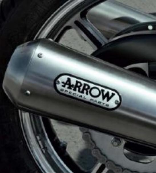
Sistema di scarico in acciaio inossidabile spazzolato sviluppato assieme ad Arrow Special Parts. Due silenziatori conici curvati verso l'alto, donano simmetria e semplicità estetica in stile classico, in linea con le normative E per il rumore. Con deflettore amovibile per l'utilizzo su circuiti e strade chiuse al traffico.
