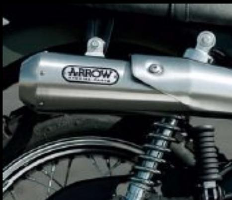
Magnificamente messo a punto assieme ad Arrow Special Parts, il sistema di scarico in acciaio inossidabile consente una notevole diminuzione del peso. Dotato di para calore, logo Triumph inciso a laser e deflettore amovibile. Solo per utilizzo su circuiti e strade chiuse al traffico. Scoprilo su [triumphmotorcycles.com](http://triumphmotorcycles.com)
