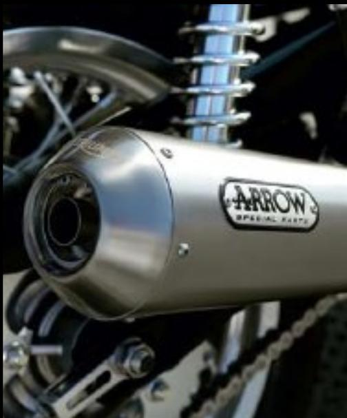
Sistema di scarico altamente performante in acciaio inossidabile 2 in 1 sviluppato assieme ad Arrow Special Parts. Look pulito e peso ridotto, in linea con le normative E per il rumore. Dotata di deflettore amovibile per l'utilizzo su circuiti e strade chiuse al traffico. Logo Triumph inciso a laser sul tappo all'estremità dello scarico.
