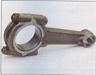
Le bielle in acciaio forgiato hanno la testa scomponibile, con cappello fissato per mezzo di due viti calibrate con dado. L'interasse tra i due occhi è di 120,5 mm.
