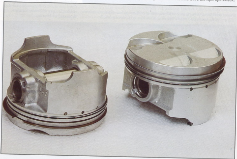
I pistoni sono fusi in lega di alluminio ad elevato tenore di silicio ed hanno il mantello alleggerito mediante ampie sfiancature laterali. Gli spinotti flottanti sono da 19 mm.
